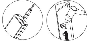
※ 3. Branchez l'appareil au secteur et mettez le sous tension, le voyant bleu sur le transformateur et le voyant vert sur le capot du robot (orange en état de charge) s'allument simultanément.
